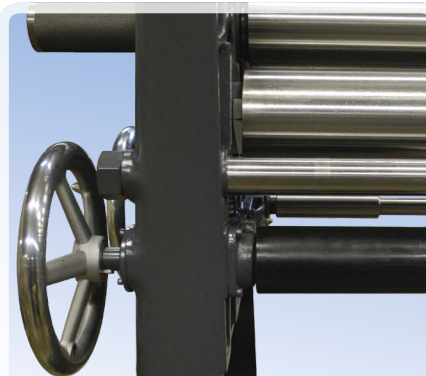
Diagonaleinstellung der unteren Walze
