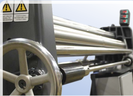
Konusbiegevorrichtung mit Diagonaleinstellung der Biegewalze, Gleitschuh und Handrad mit Register
