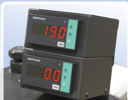
Visualizador digital de cota para indicar la posición de los rodillos curvador y/o inferior
