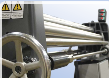
Dispositivo de curvado cónico incluye regulación diagonal del rodillo curvador, calzo corredizo y volante con esfera de registro
