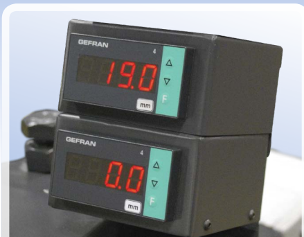
Digital display för böj- och/eller undervalsar. Finns även för visning av matningslängd
